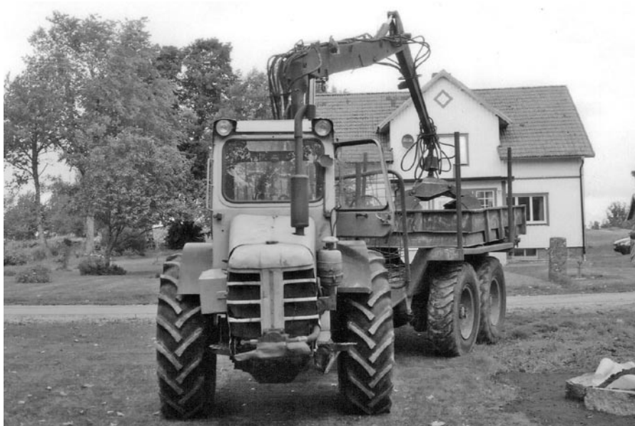
Porsche-traktor utan framvagn med tillkopplad driven skogskärra.
